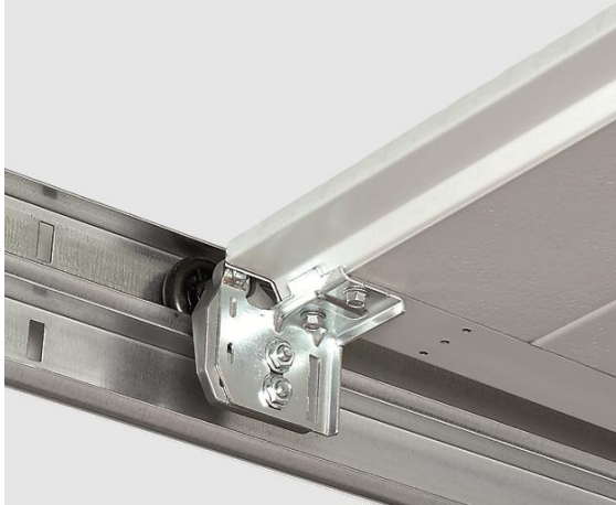
Bild 8: Die patentierten Sicherheitslaufschienen, Laufrollen und Rollenhalter verhindern ein Entgleisen und somit einen Absturz des Tores.
