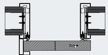
Schiebetürzarge vor der Wand laufend, dicht schließend
